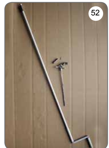
Handkurbel, Kardangelenk 45 Grad oder 90 Grad mit Kupplungstrichter [52]
